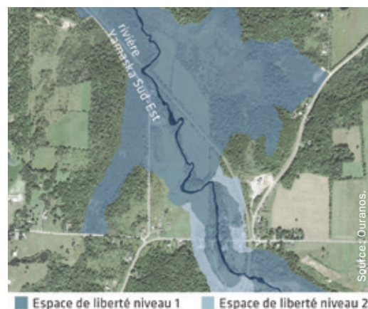
Figure A1.a L'ESPACE DE LIBERTÉ DES RIVIÈRES
