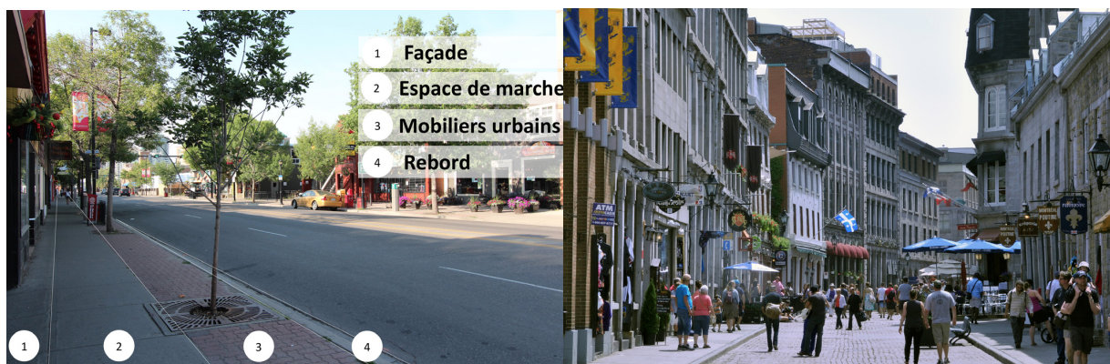
Division de l'espace d'un trottoir, Calgary. Source: Piétons Québec / Crédit: daveblogs007 via Flickr
