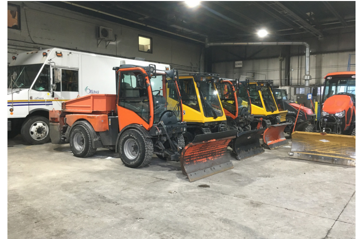
Image 6.5. Véhicules d'entretien et chasse-neige pour les trottoirs et les pistes cyclables d'Ottawa
