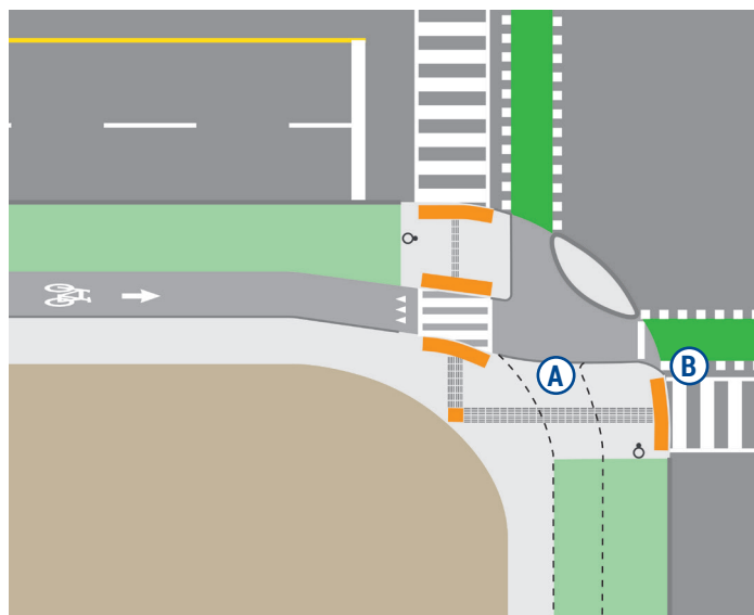
Figure 5.12. Angle protégé standard doté d'une transition menant à une grande voie publique sans infrastructures cyclables
