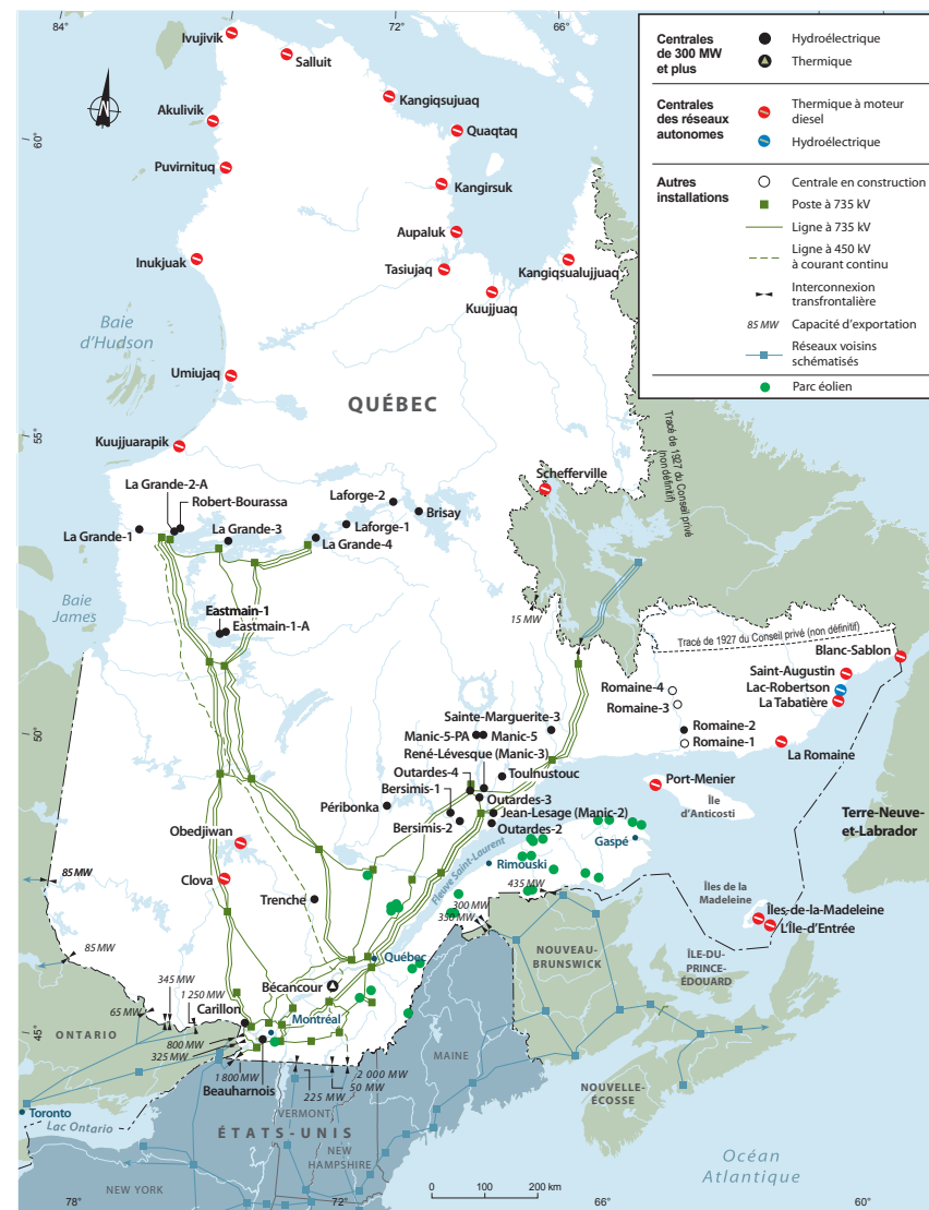
GRAPHIQUE 3.2.8 • CARTE DES PRINCIPAUX ÉQUIPEMENTS DE PRODUCTION ET DE DISTRIBUTION D'ÉLECTRICITÉ AU QUÉBEC, 2014
