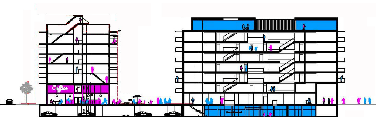
Figure 15 : coupe schématique des deux immeubles :Architectures Superblock et Einszueins .© Wohnen mit Alles
